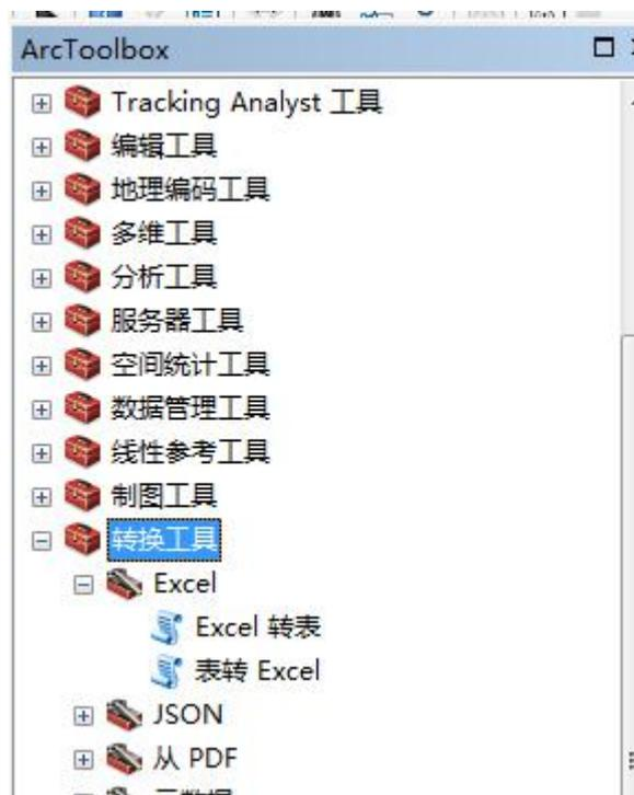
2) 双击打开表转 Excel 对话框，输入表选择动态图层即为输入其属性表，选择输出路径并命名即将输出的 excel 表，点击确定，即可完成转换，
